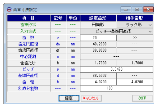
図 50.5 歯車寸法設定（ラック工具）
